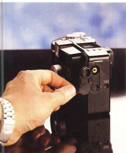
L'uscita videocomposita (per l'anteprima su monitor a colori) e la porta seriale per il computer.
